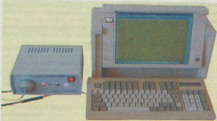
Urządzenie (spektrofotometr i „niebieski laser” wraz z układem emisyjnym – detekcyjnym) stosowane do wykrywania „in vitro” niestabilnych blaszek miażdżycowych, stosowane w badaniach prowadzonych przez Pracownię Hemodynamiki Kliniki Kardiologii AM.
