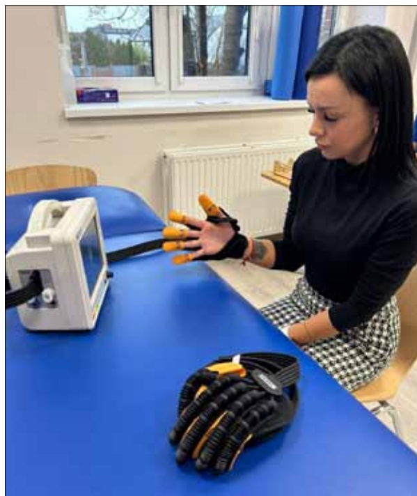
Robot do rehabilitacji ręki
